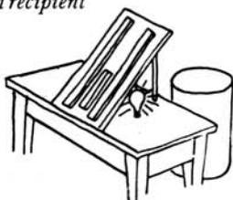
placé derrière la table et destiné à recevoir la pellicule au fur et à mesure qu'elle sort à l'extrémité supérieure de la rainure. La distance de chute doit être suffisante pour que l'image dessinée à l'encre sur la pellicule ait le temps de sécher avant de toucher le fond du récipient.
